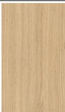
Stratifié bestaat uit opeengestapelde papierbladen die doordrenkt zijn met hars. Tijdens de productie worden deze lagen samengeperst onder hoge druk (8MPa) en bij een hoge temperatuur (150°C). De gebruikte hars is een thermoharder.
