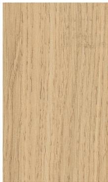
Stratififié bestaat uit opeengestapelde papierbladen die doordrenkt zijn met hars.
